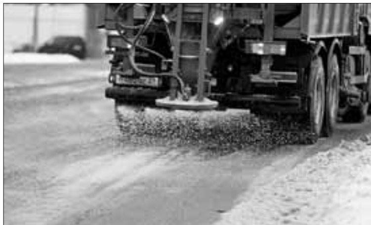
■ КДМ могут одновременно чистить проезжую часть и проводить обработку смоченной солью
