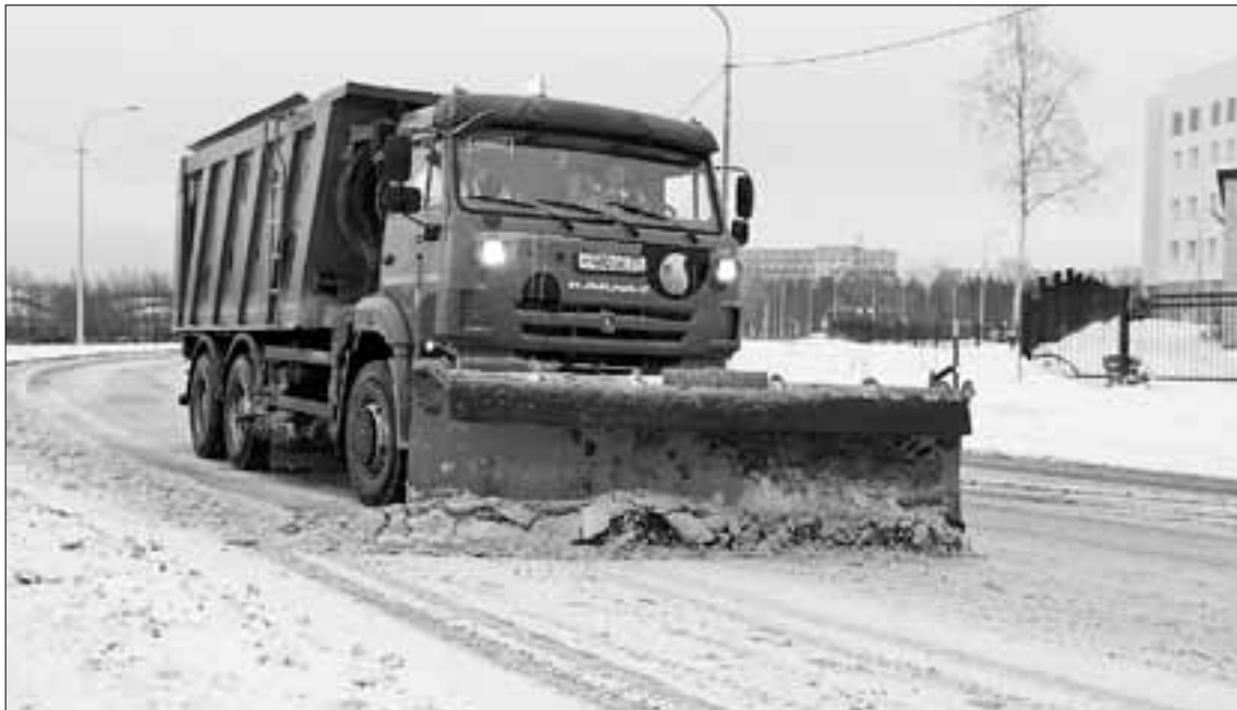
■ КДМ могут одновременно чистить проезжую часть и проводить обработку смоченной солью
